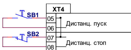
Рисунок 6 – схема подключения кнопок дистанционного пуска и сброса.
