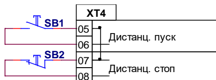
Рисунок 6 – схема подключения кнопок дистанционного пуска и сброса.
