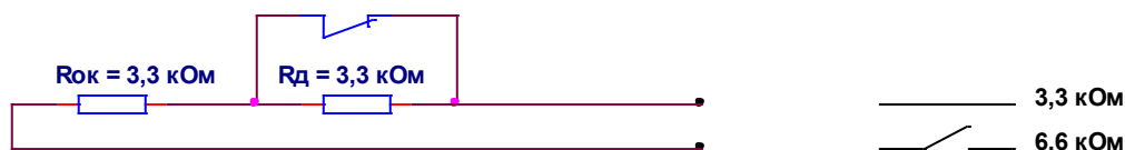
Рисунок 1 – схема подключения контактов и резисторов для линий ОПН и РПН.
